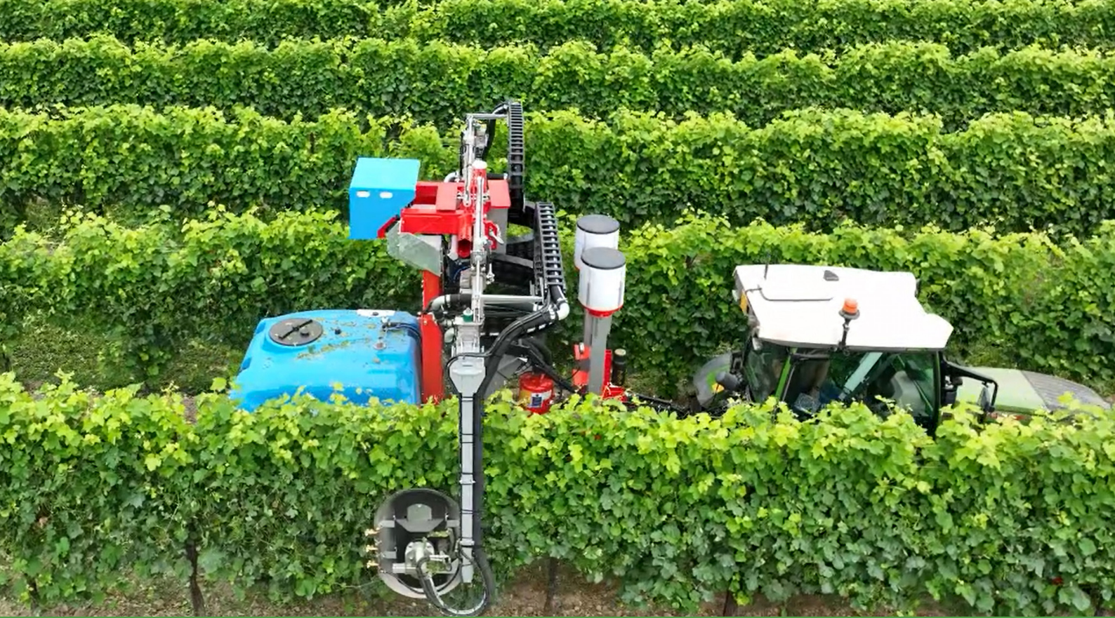
Entlaubung - Maschine im Feld wehrend der gezielten Behandlung von zwei Reihen.
